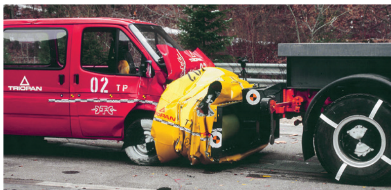
La TMA et la zone de déformation ont contribué à transformer l'énergie de manière efficace et préventive.
