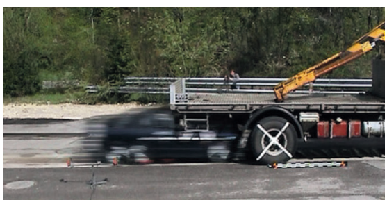
La Nissan s'écrase sur l'axe arrière du véhicule FBW env. 70 ms
